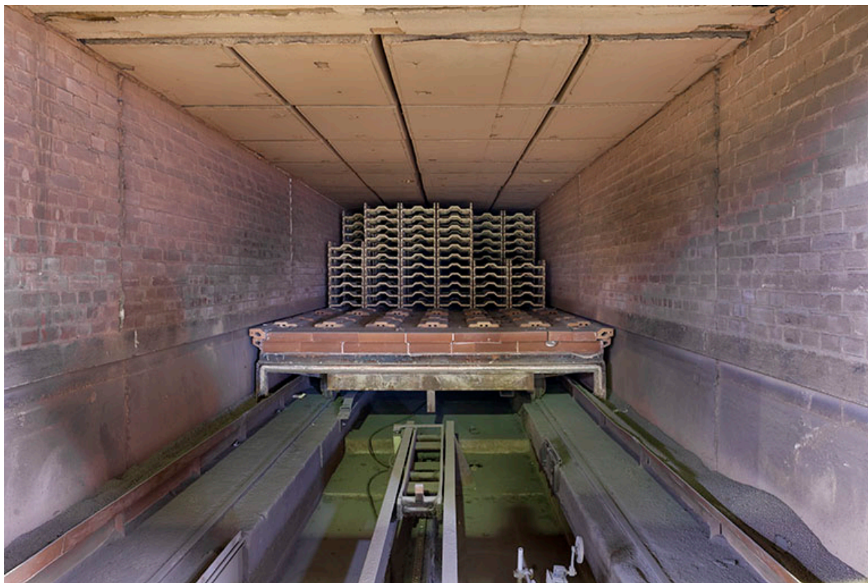
Unité de fabrication dite UL 1. Intérieur du four désaffecté, avec son chariot et les supports réfractaires.
