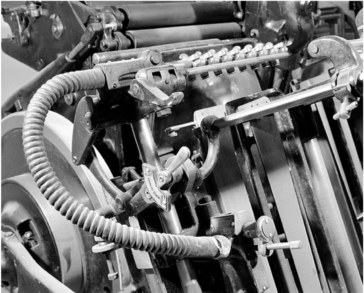
Détail du margeur automatique, avec son système de ventouses (suceurs) pneumatiques.
