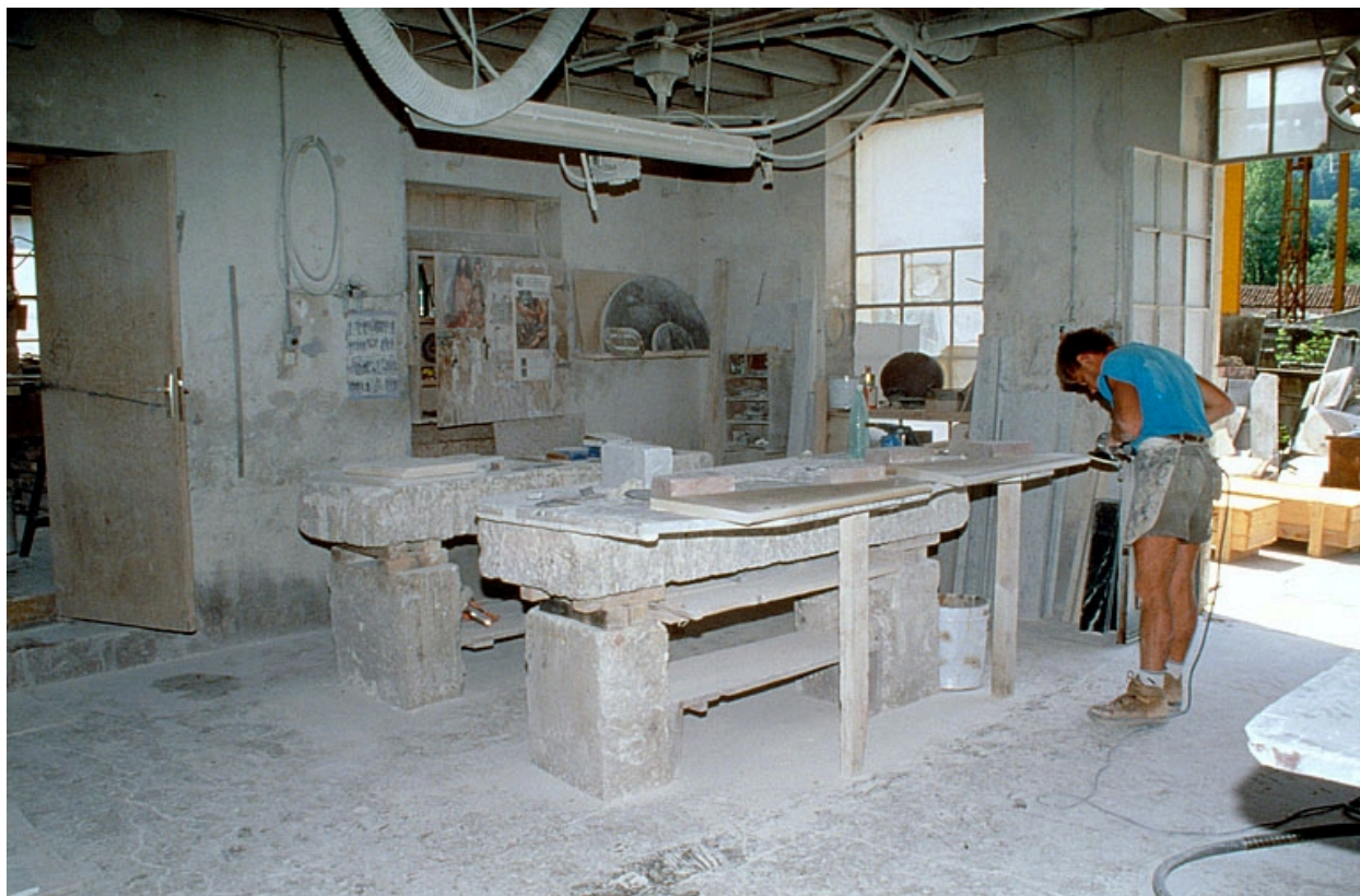
Usine de taille de matériaux de construction Yelmini Artaud, à Balanod : polissage du chant d'une marche d'escalier à l'aide d'une meuleuse.
