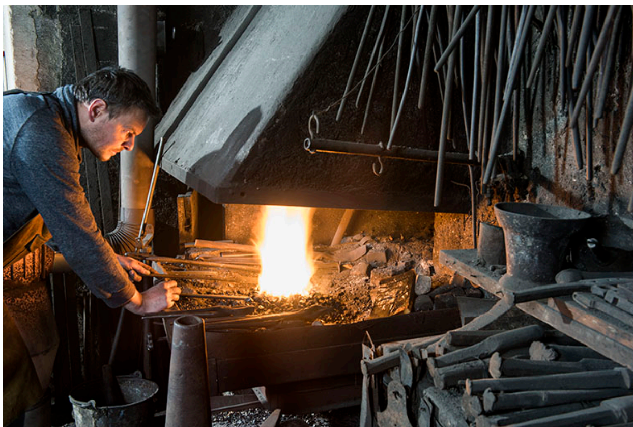
Ferme, atelier de taillanderie et de tournerie Vuillemin, Grand'Combe-Châteleu : chauffe dans la fournaise.
