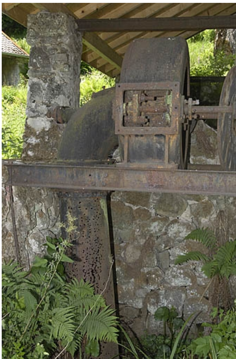
Turbine horizontale et sa conduite d'évacuation.
