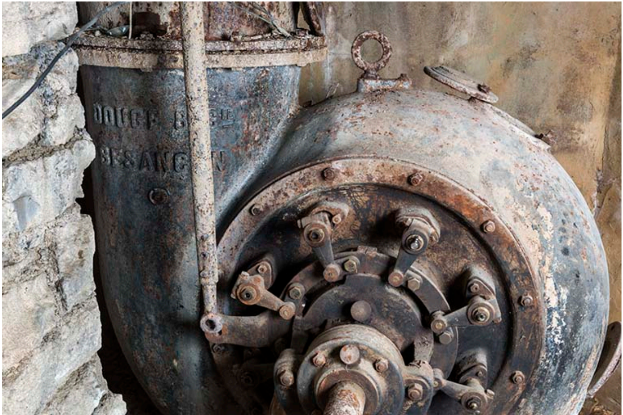
Atelier de fabrication, sciurier : turbine Douge.
