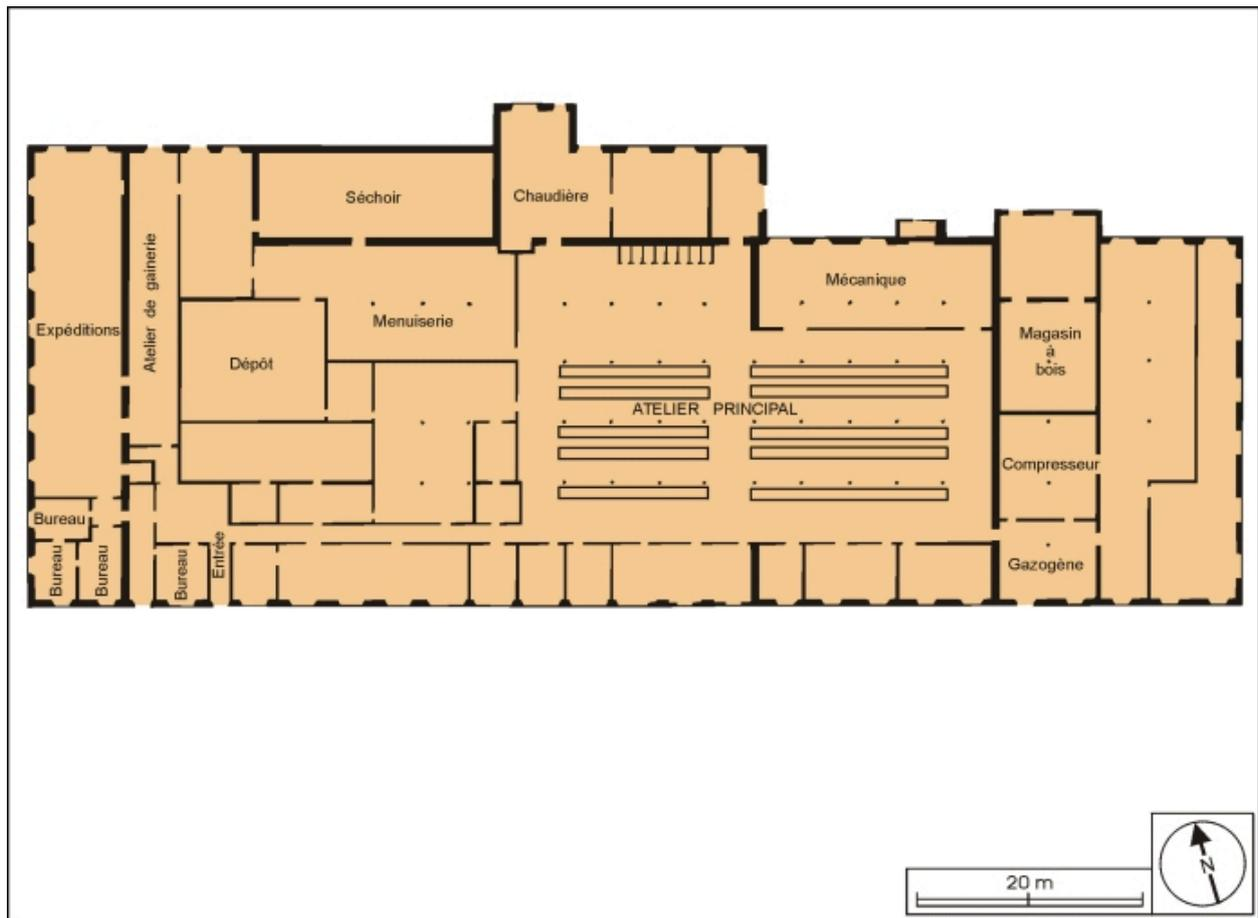
Plan-masse de l'usine (3e quart du 20e siècle). D'après un plan de l'usine, mis au net par A. Céréza, échelle 1:600.
