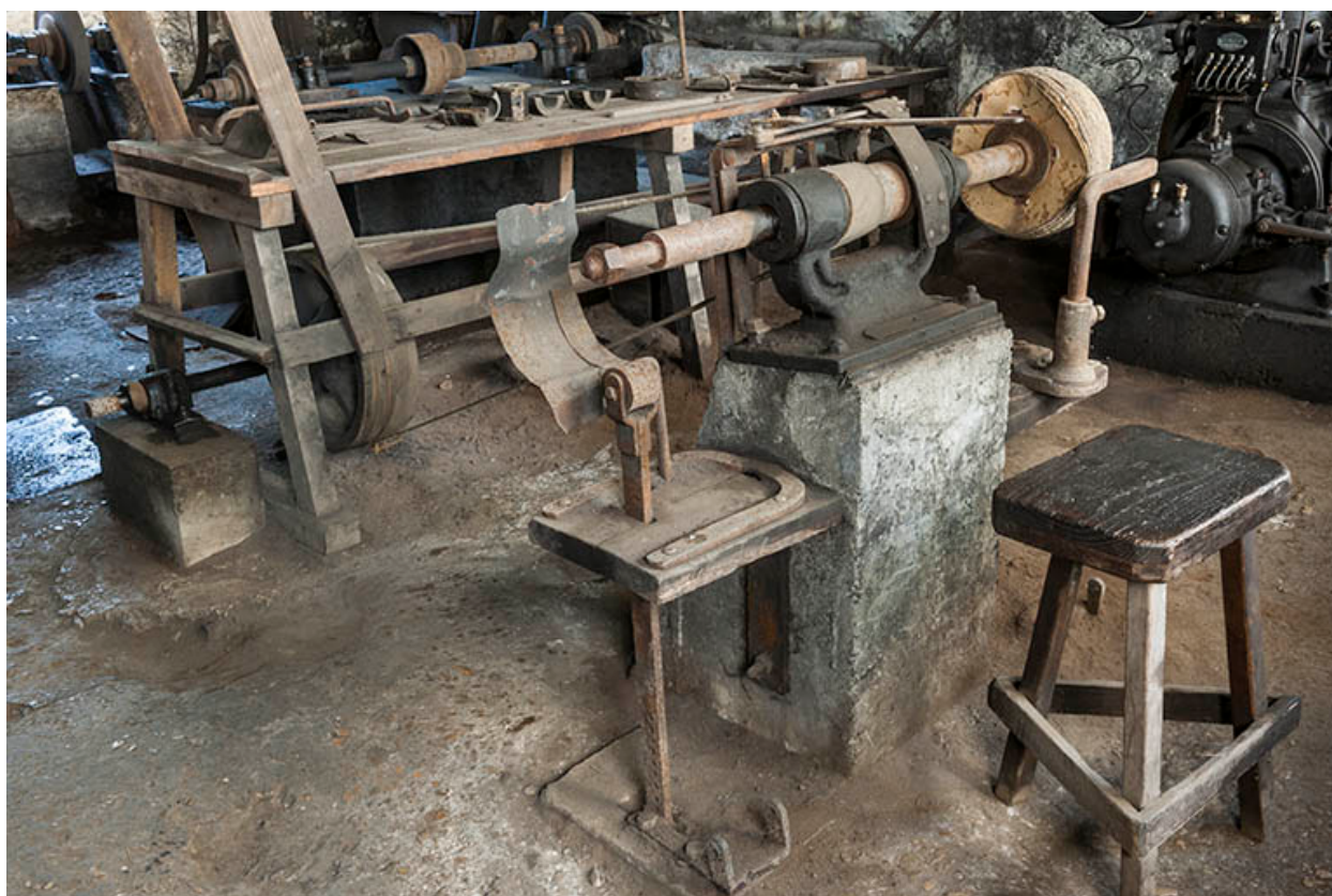
Atelier de mécanique. Poste de polissage.
