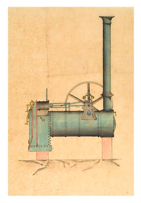
Plan d'ensemble des ateliers Frézard. Elévation de la machine à vapeur.
