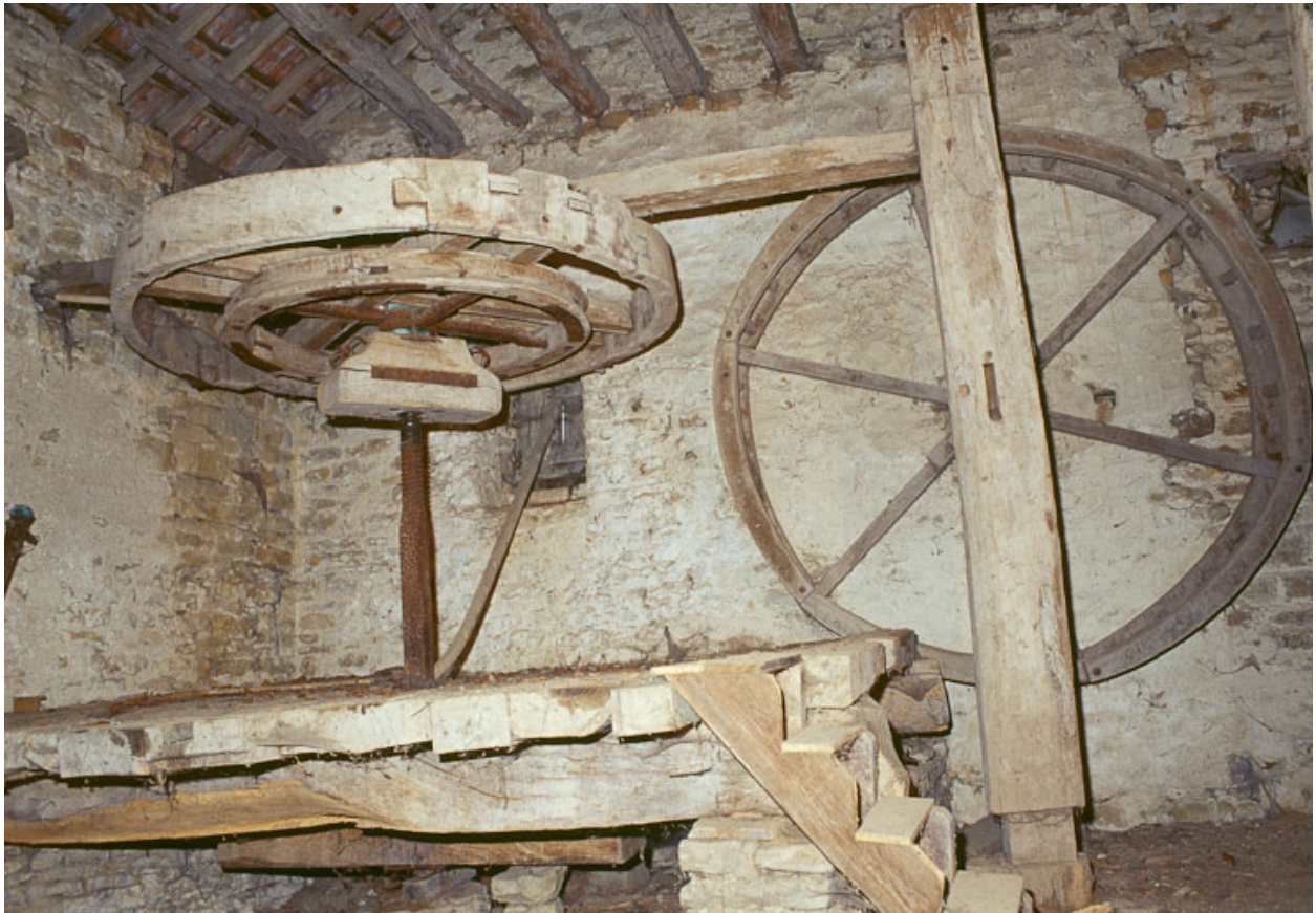
La maie, la roue de presse et la roue à écureuil.
