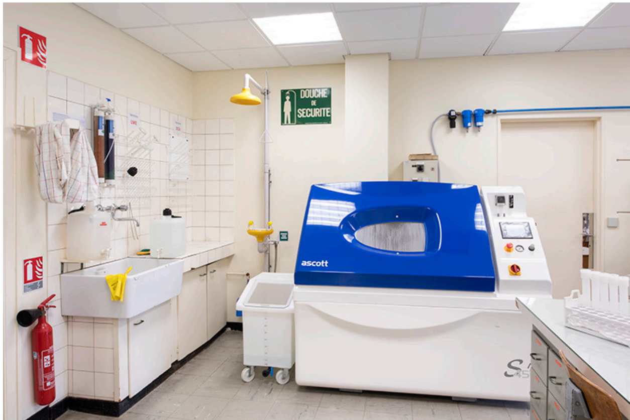
1er étage de soubassement, laboratoire de chimie : machine à brouillard salin et pailasse.
