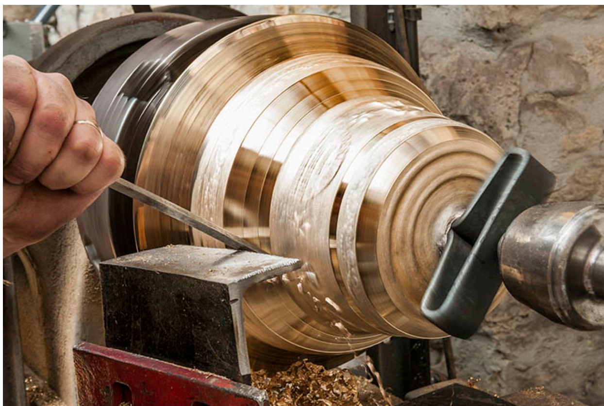
Tournage d'une cloche. Détail.
