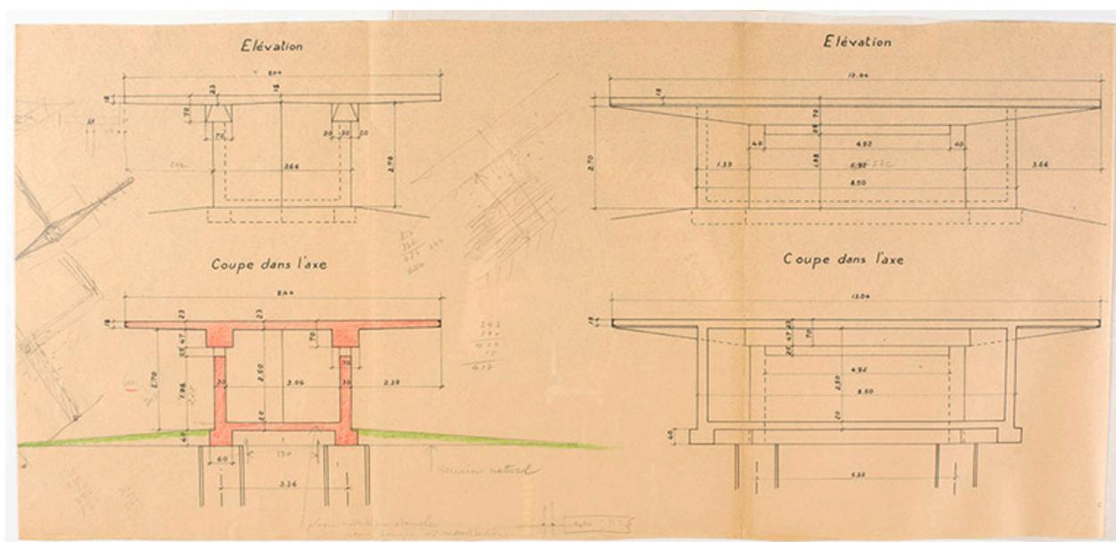
Cahier de coffrage et armature de la structure de la pile et du plancher du premier étage, s.d.
