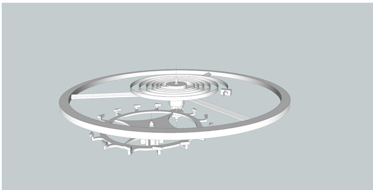
Echappement à cylindre. Le cylindre et la roue de cylindre sont visibles sous le balancier-spirale.
