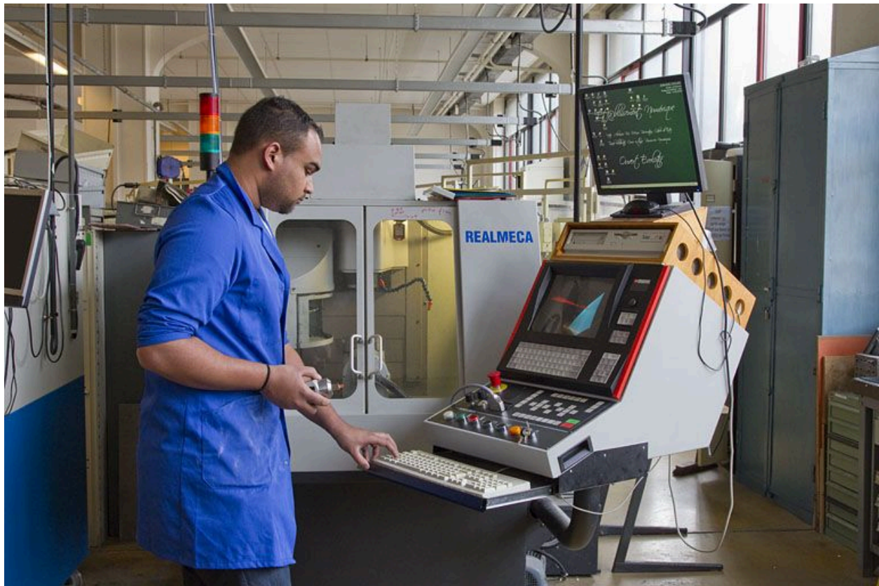
Bâtiment B, atelier de mécanique : machine à commande numérique (centre d'usinage 5 axes).
