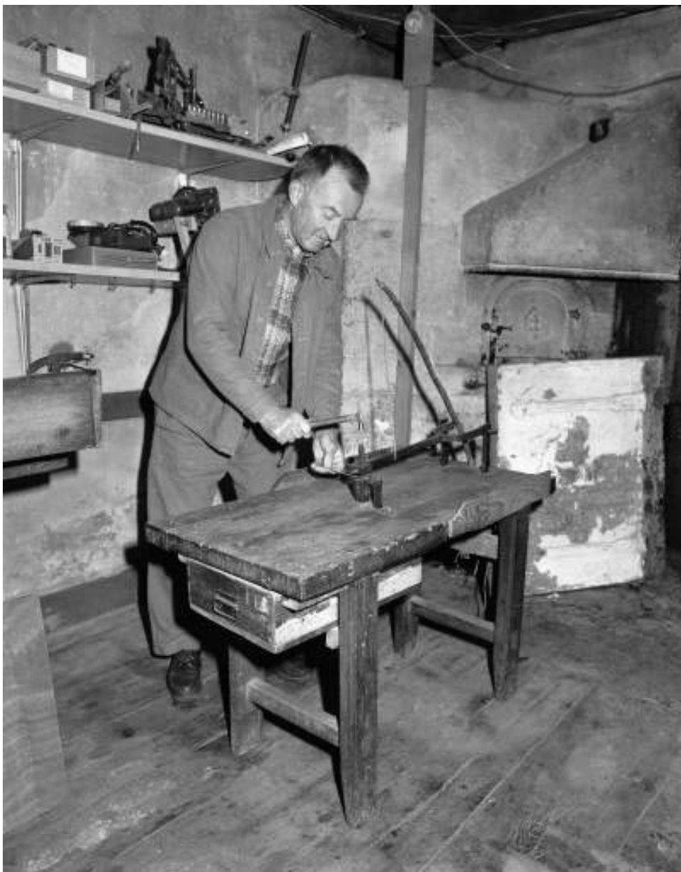
Poinçonnage d'une lame.
