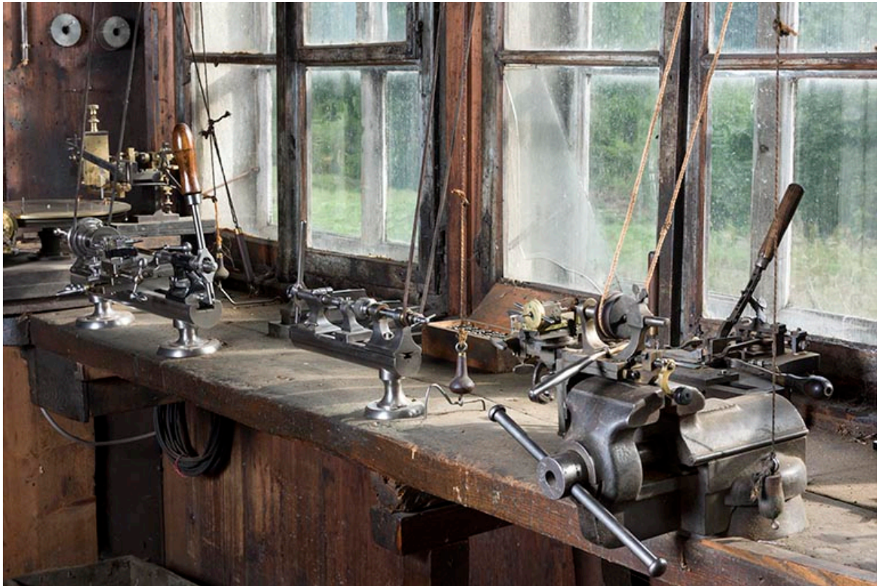
Fabrique d'outillage : tours fixés à l'établi pour un travail "sur la fenêtre".
