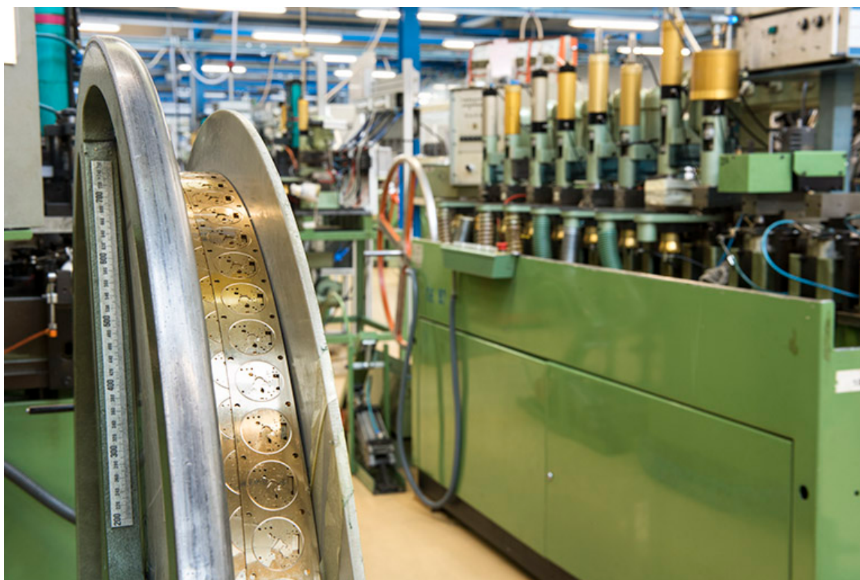
Atelier d'usinage : bande de laiton usinée.
