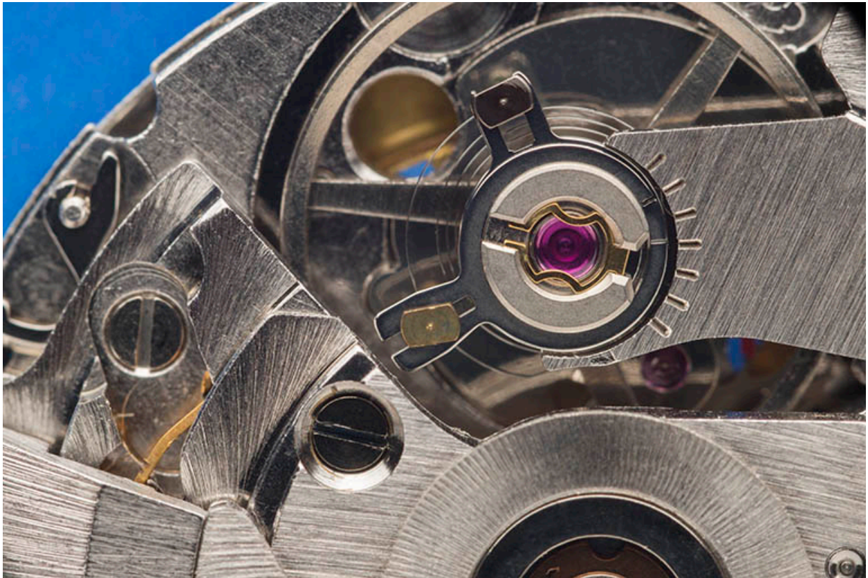
Détail de la face côté ponts : amortisseur de chocs Incabloc, raquette et balancier-spiral.
