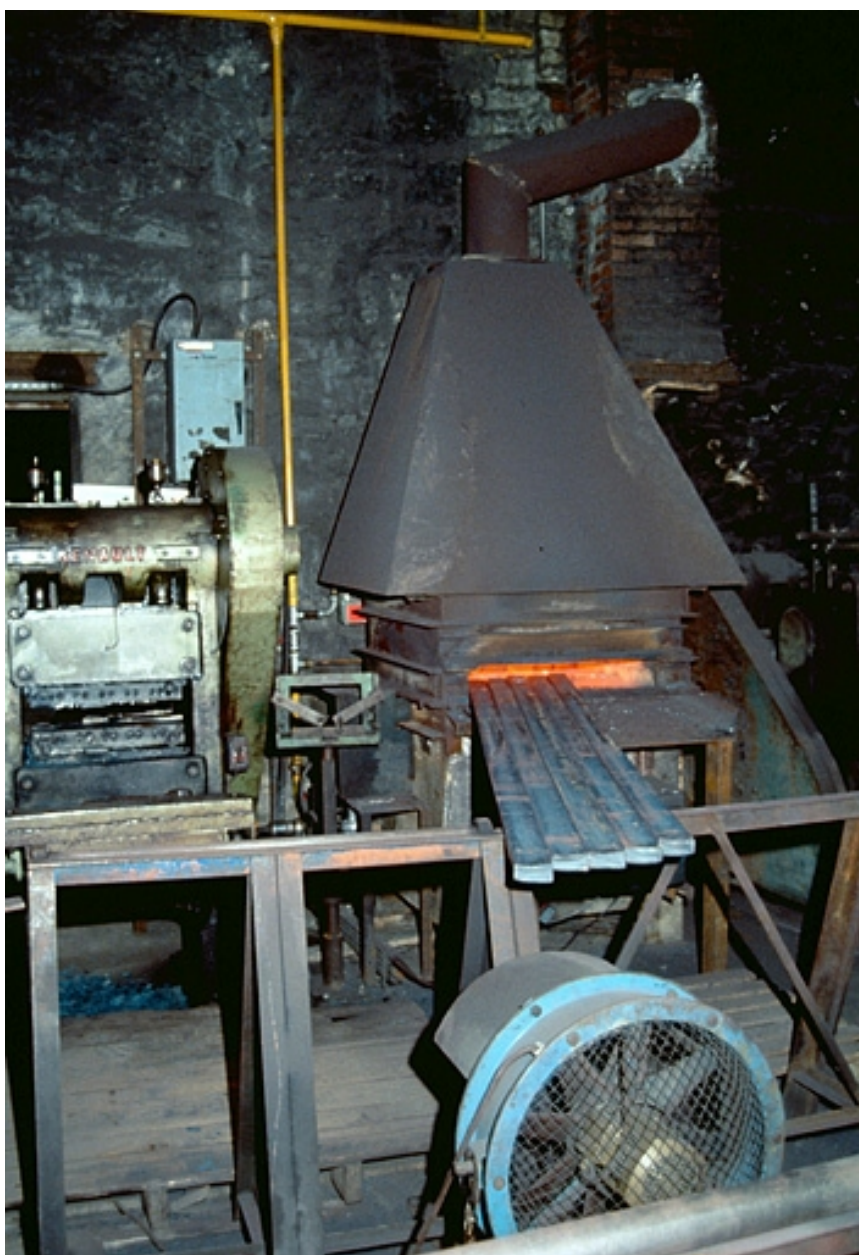
Atelier de pose des soies : chauffage des barres.
