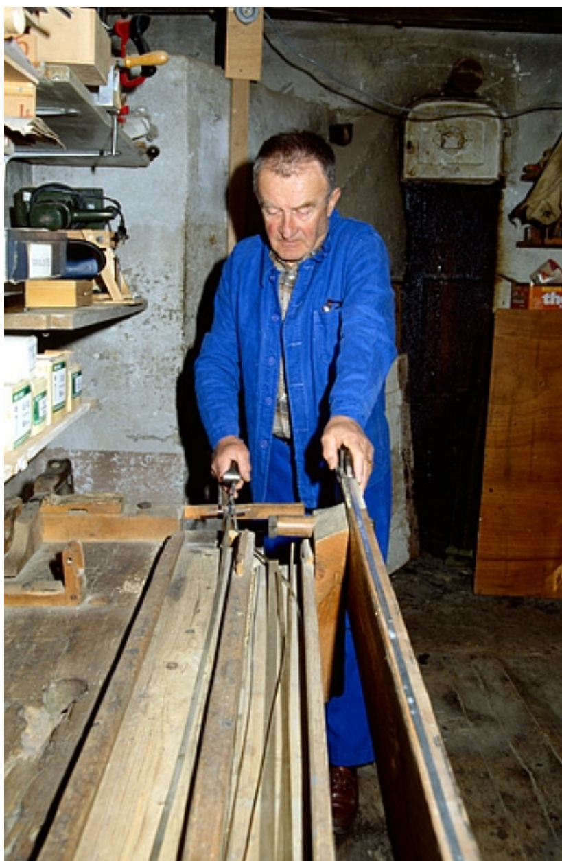
Ebarbage d'une bande de métal (sur le banc à racler).
