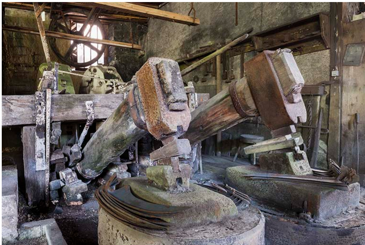
Les bras des martinets et leur bâti.
