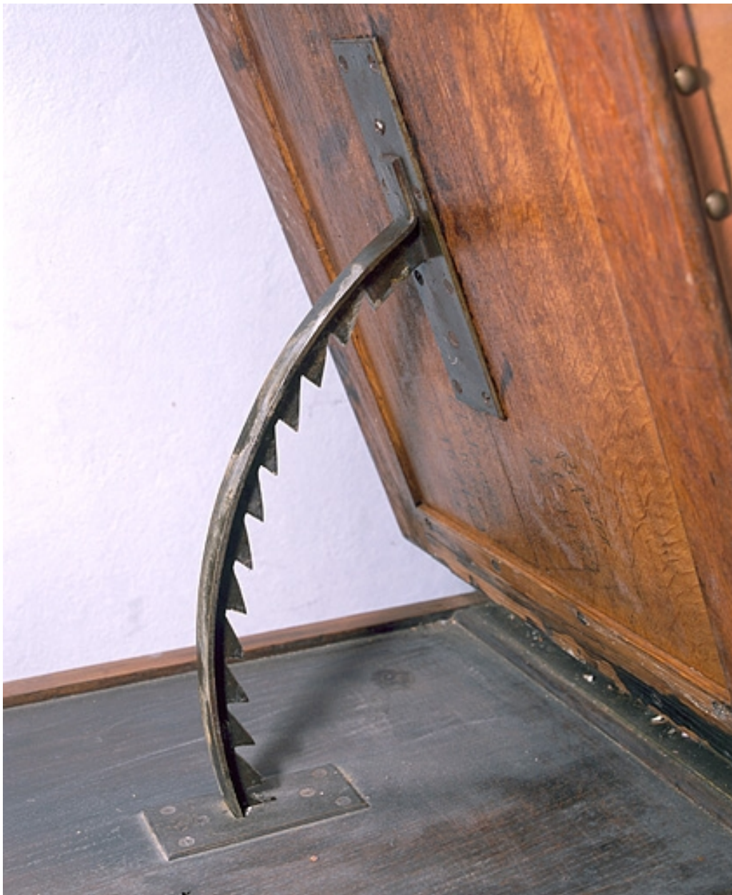
Mécanisme d'inclinaison du dossier.
