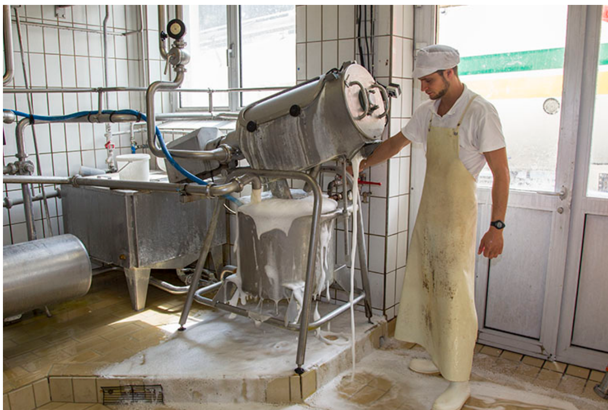
Nettoyage des installations : filtre à sérum.
