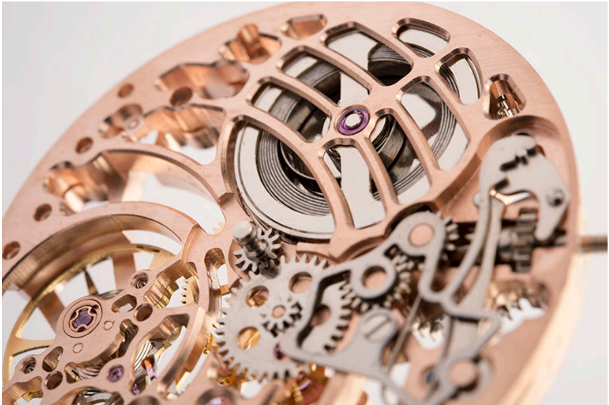
Mouvement rose, détail côté cadran : amortisseur de chocs (à gauche), tirette et pont de barillet (avec ressort moteur).
