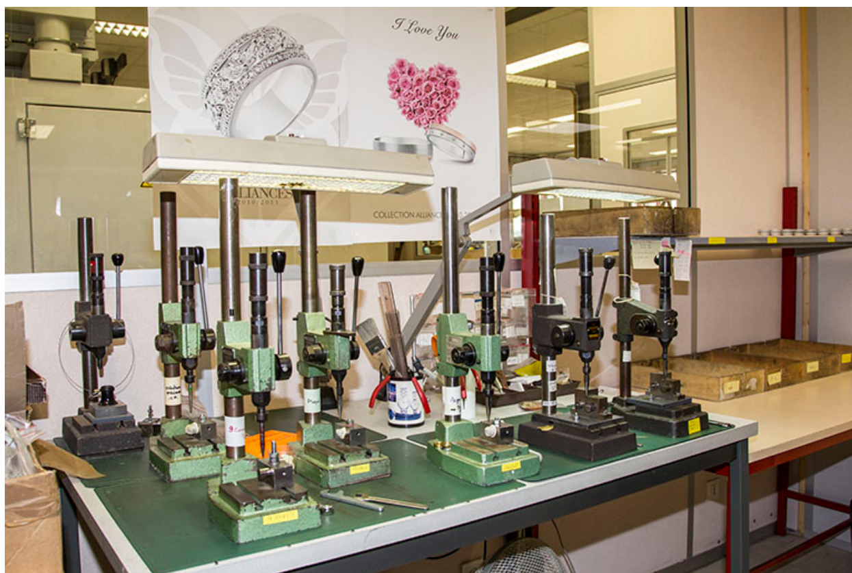
Atelier de poinçonnage : machines à poinçonner.
