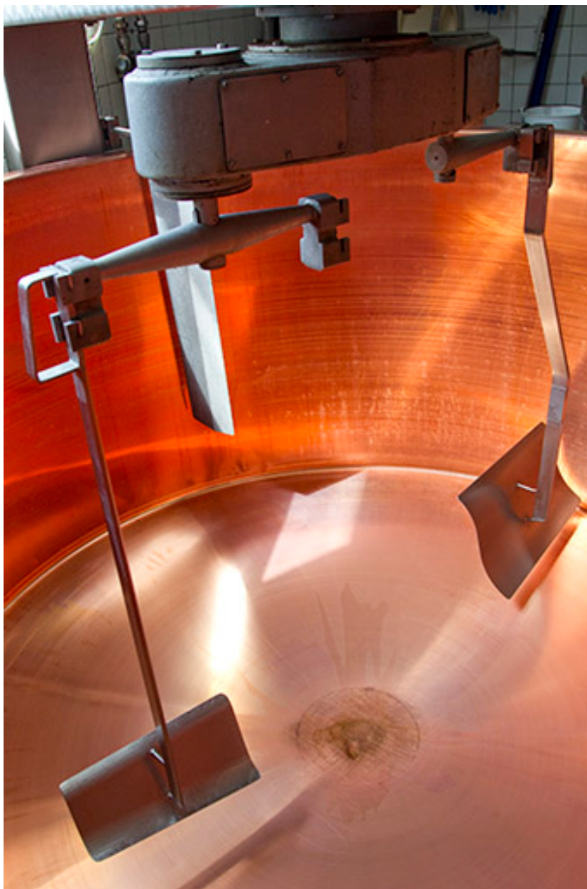
Cuve de fabrication : outils de brassage.
