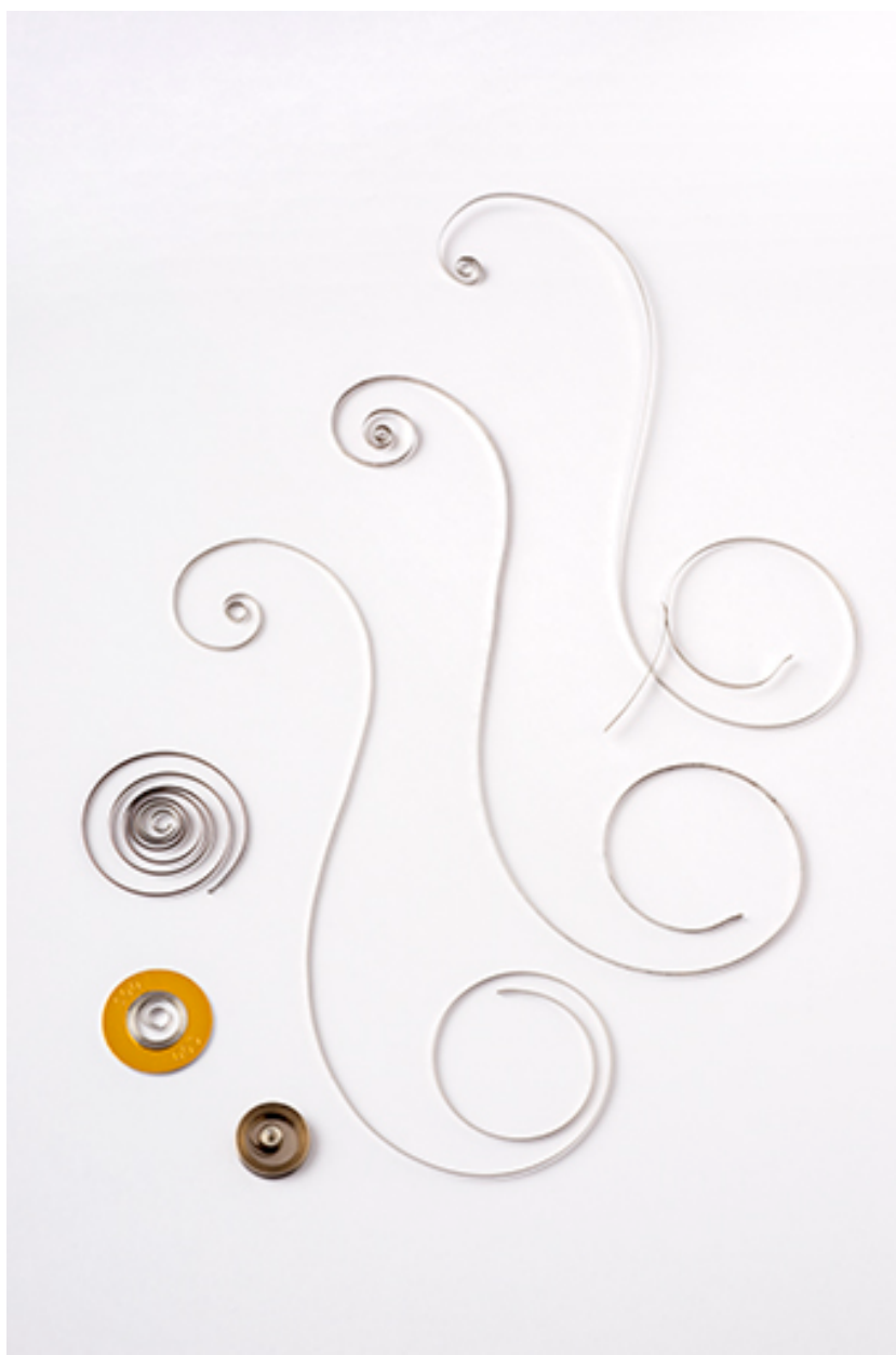
Barillet démonté et ressorts moteurs.
