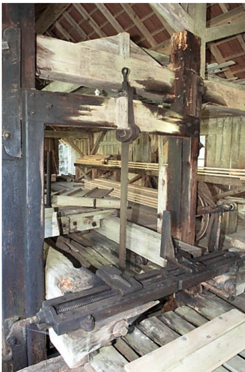
Scierie Lamboley, Miellin (le Miellenot) : châssis de scie monolame.
