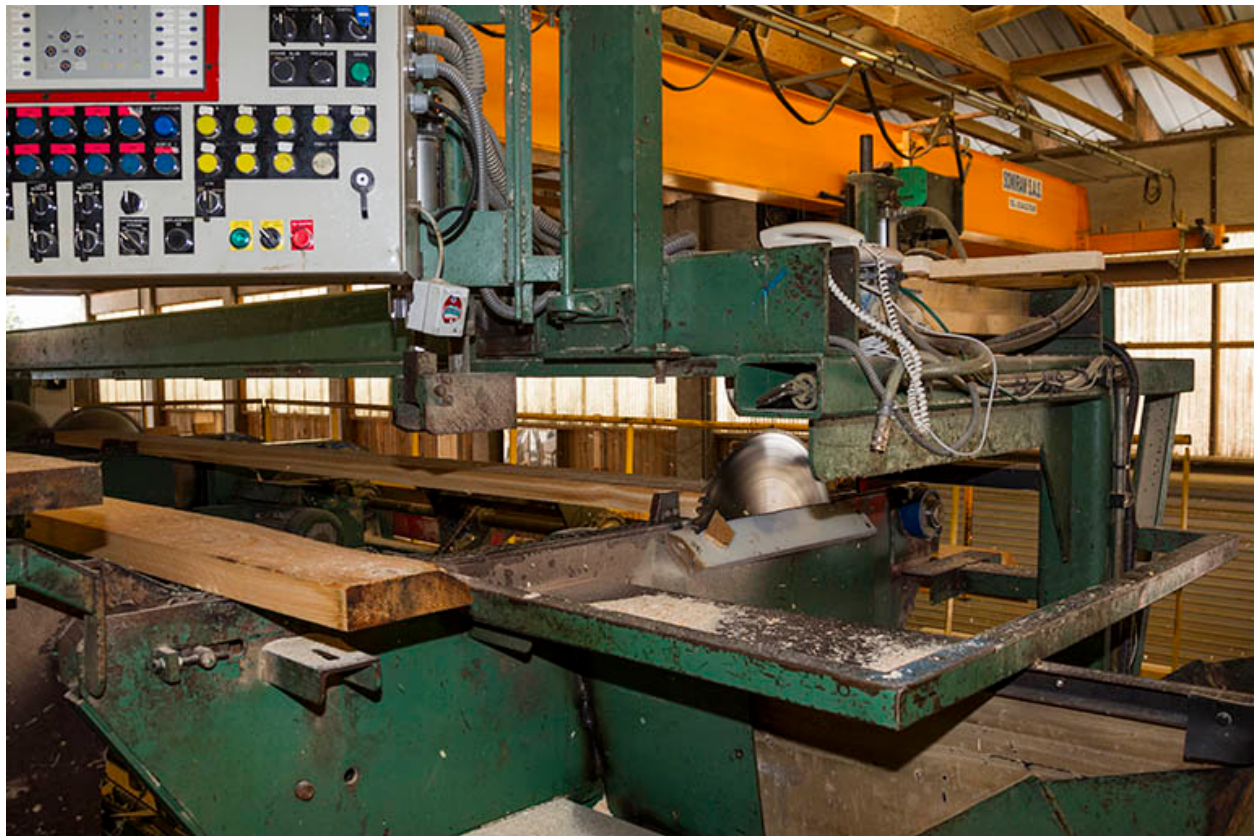
Atelier de triage et d'empilage (E) : scie circulaire de l'installation de sciage.
