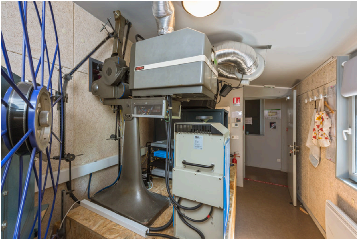
Cabine de projection. Au centre le projecteur argentique Fedi XV T et son redresseur Irem.
