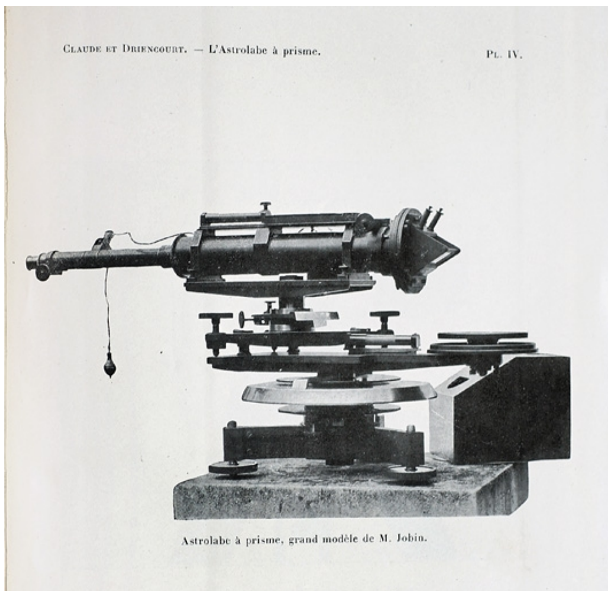
Astrolabe à prisme, grand modèle de M. Jobin, 1910.
