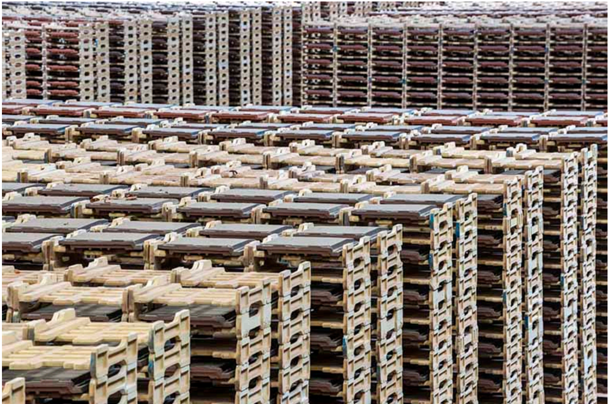
Unité de fabrication dite UL 2 (à l'arrêt). Empilement de tuiles sur chariots réfractaires (pour four piscine).
