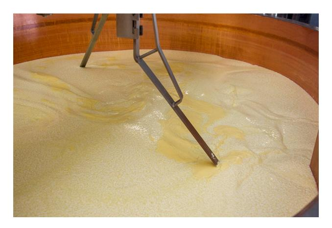
Fabrication : chauffage et brassage du lait.
