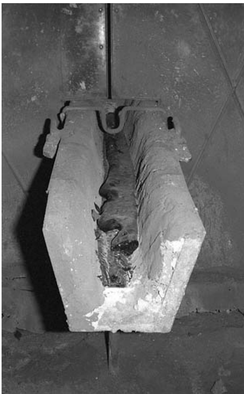
Grand cubilot. Détail de la rigole de coulée.
