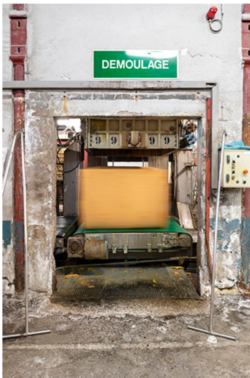
Fabrication : démoulage du bloc.
