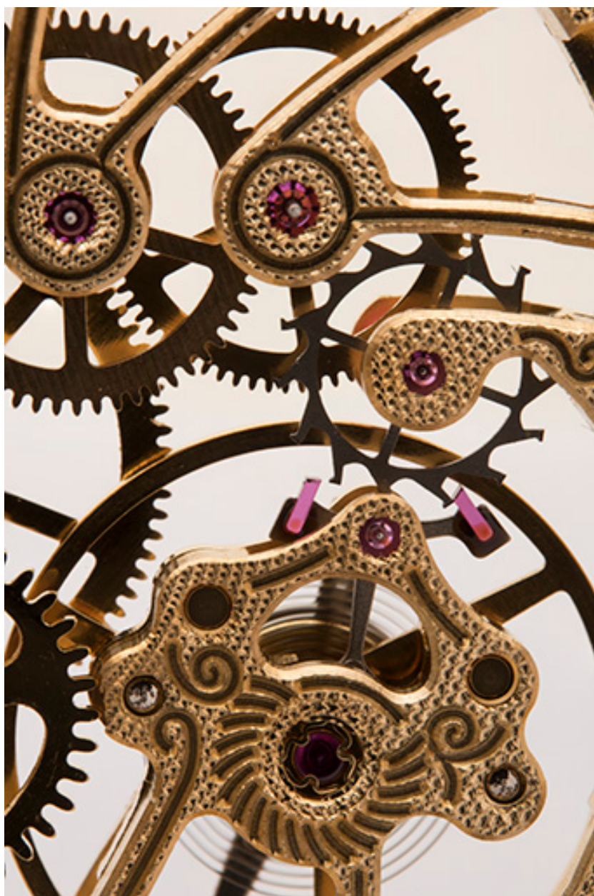
Détail : échappement à ancre (avec le coq au premier plan).
