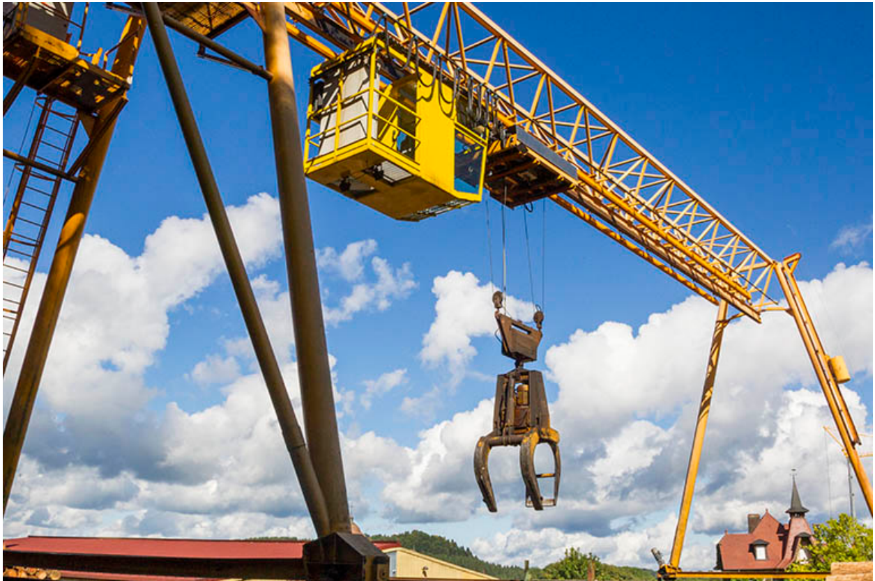
Portique roulant : cabine de commande et pince.
