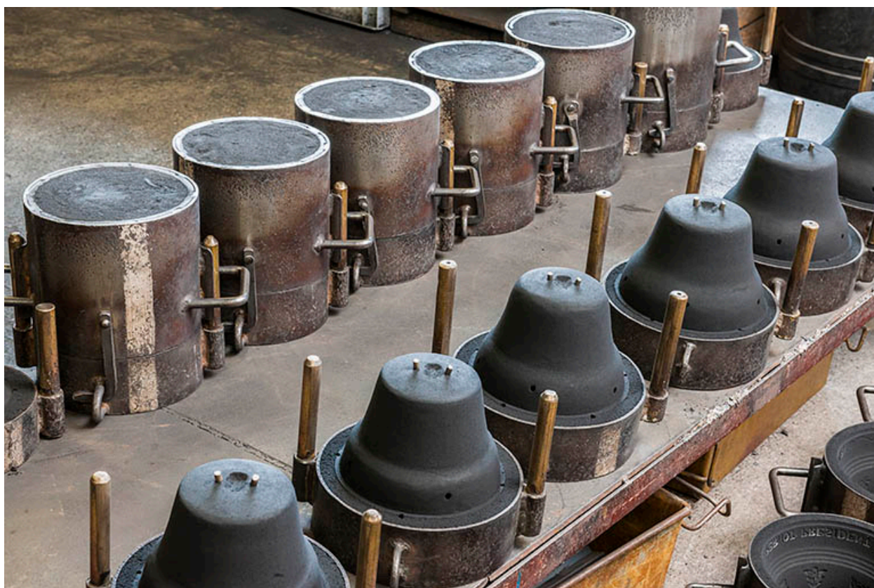
Châssis et moulages avant assemblage.
