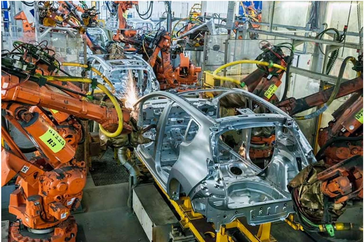
Atelier de ferrage. Robots de soudage sur la caisse en blanc (2).
