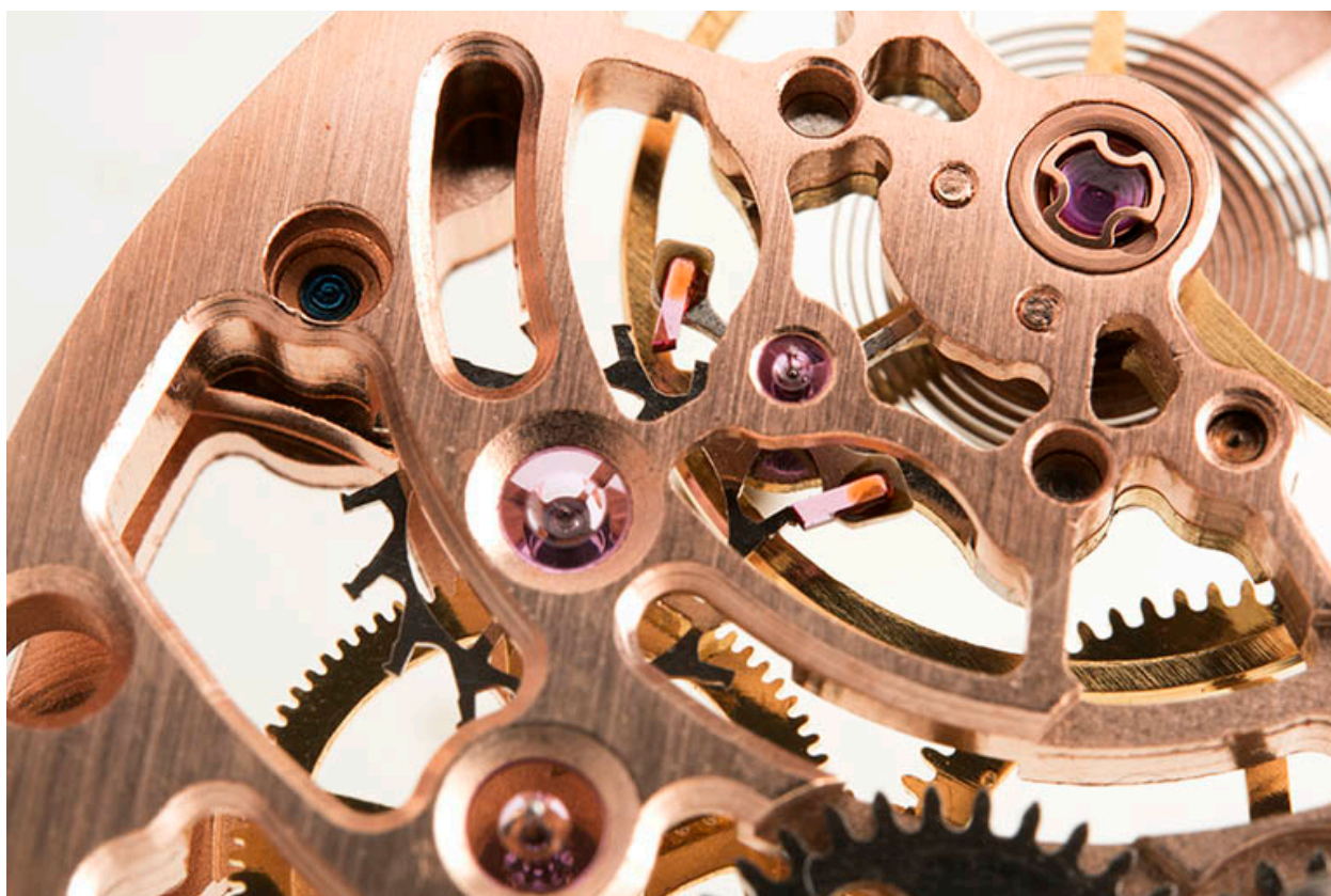
Mouvement rose, détail côté cadran : rubis et amortisseur de chocs.
