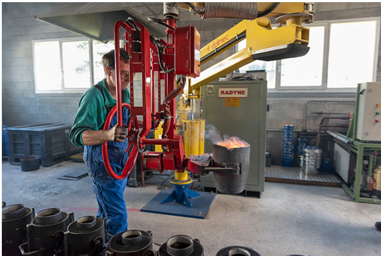
Transport du creuset (poche) plein de bronze en fusion, à l'aide de la grue d'atelier.
