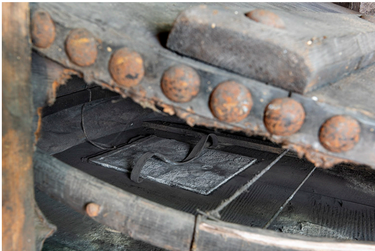
Forge : intérieur du soufflet en cuir montrant un clapet.
