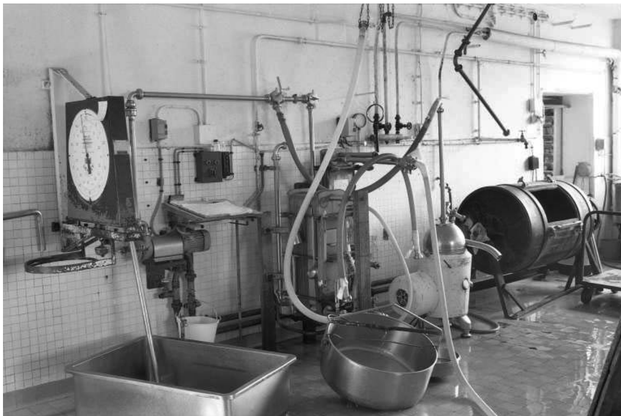
Atelier de fabrication : pèse-lait, écrémeuse et baratte.
