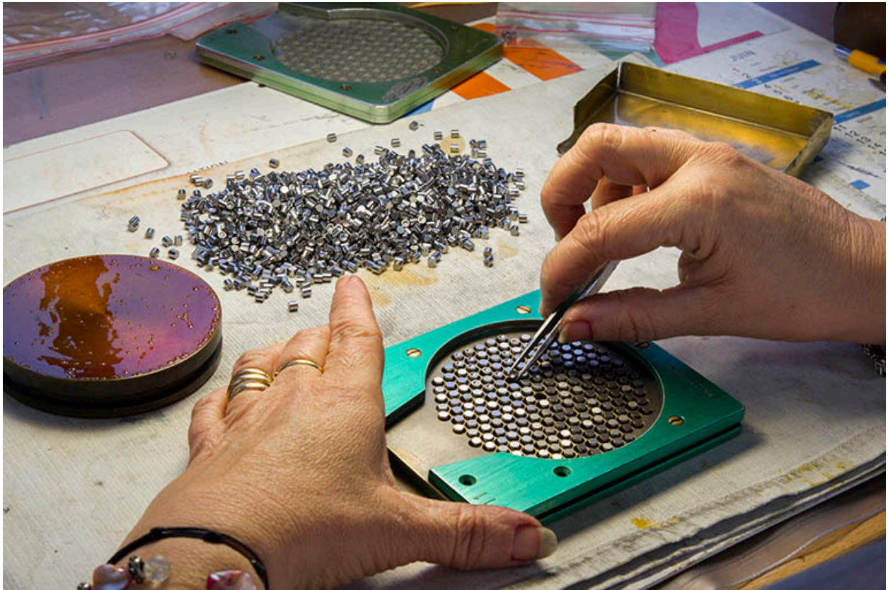
Atelier de polissage : mise en place des pièces sur un plot.
