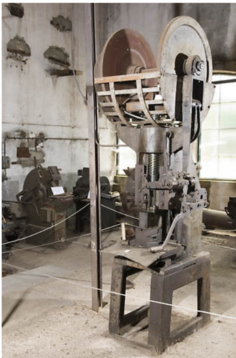
Atelier ouest. Presse à friction.
