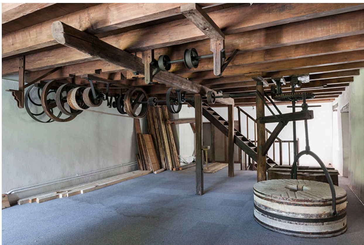
Premier étage. Transmission par poulies et meules.
