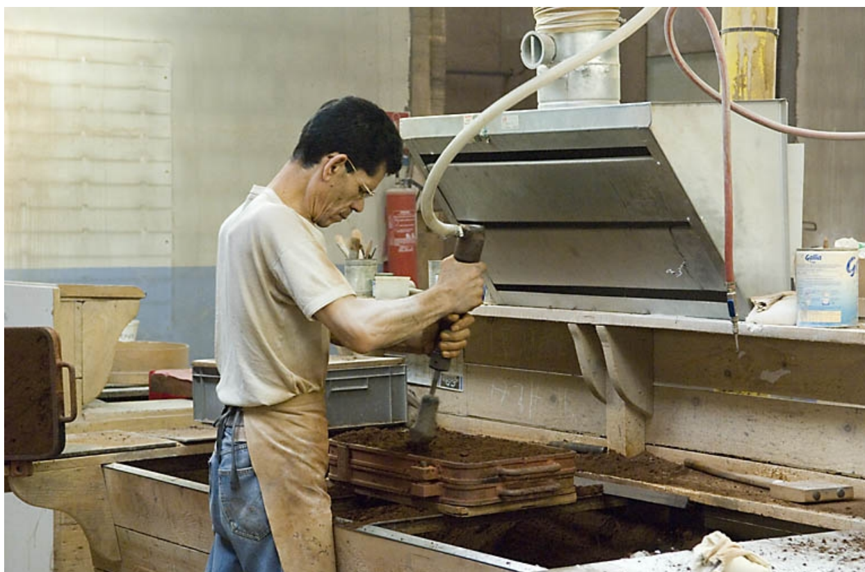
Poste de moulage. Le sable est tassé avec un outils pneumatique.
