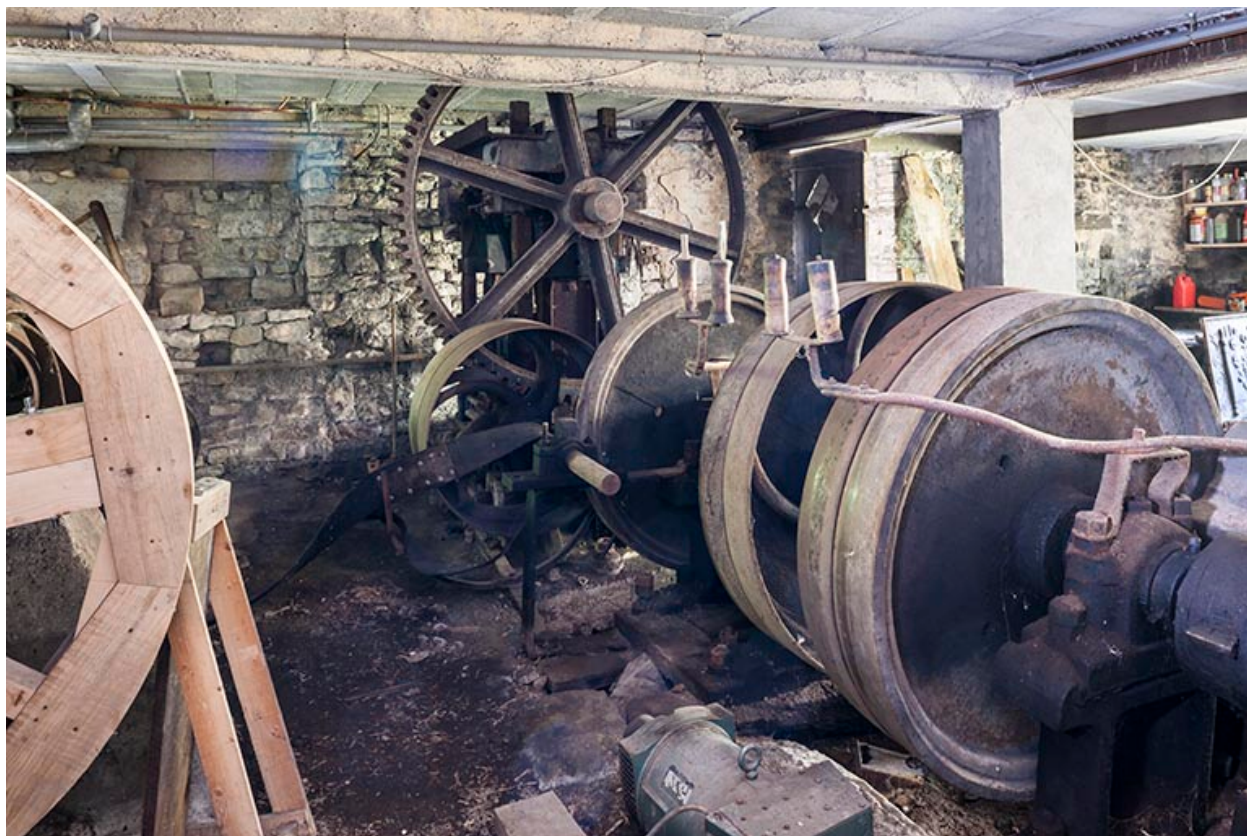
Système d'entraînement des martinets (volants de transmission et d'inertie).
