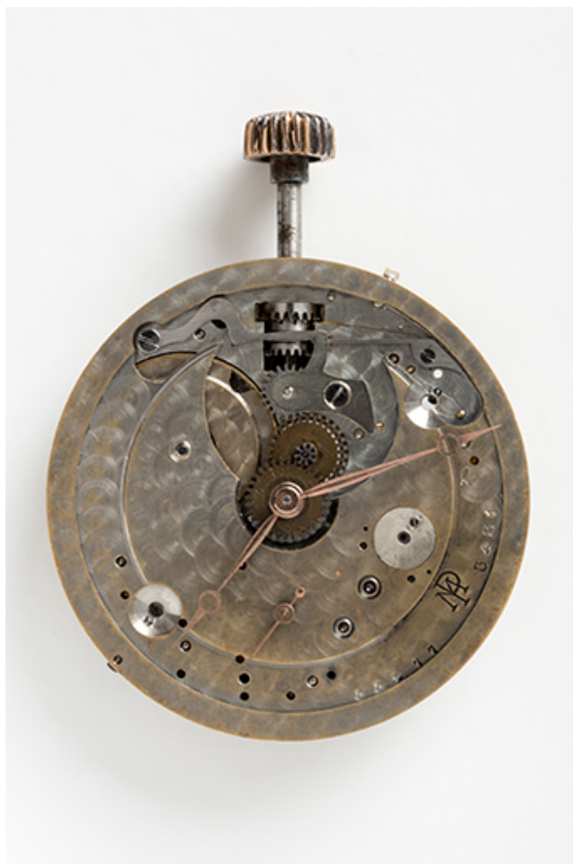
Mouvement Parrenin-Marguet : face côté cadran.
